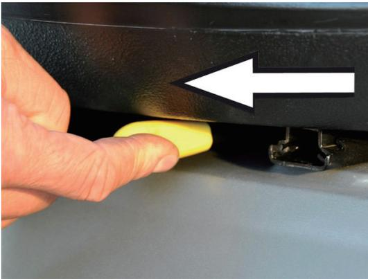
シート前方下部の黄色のレバーを引き上げシートを前後に移動し最適なポジションに調整してください。
