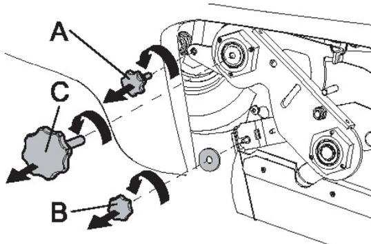
アーム固定ボルト・フラップ固定ナット・スイングアーム固定ナットを取り外してください。
