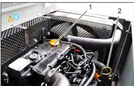
1 Мастилоналивна кришка (двигун) 2 Показник рівня мастила
