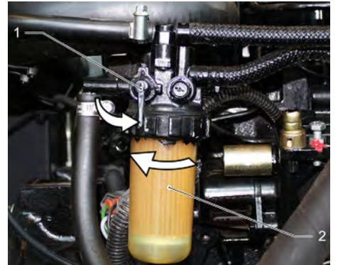
1 Паливний кран 2 Паливний фільтр → Закрити паливний кран. → Відгвинтити та замінити паливний фільтр.
