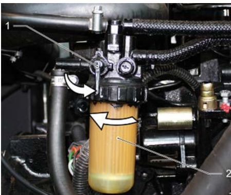
1 Топливный кран 2 Топливный фильтр
