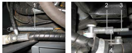
1 Opruga 2 Matica za namještanje 3 Protumatica 4 Navojna šipka
