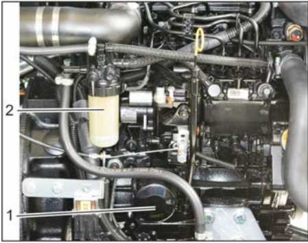
1 Filter motornog ulja 2 Топливный фильтр
