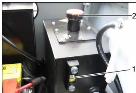
1 Масломерное стекло для гидравлического масла 2 Крышка, отверстие для заливки масла
