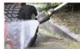
La boquilla triple de KÄRCHER permite seleccionar entre el chorro concentrado y en abanico.
