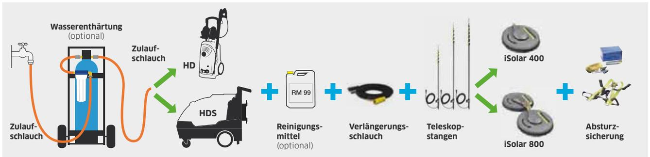
Die Bürsten iSolar 400 und iSolar 800 verfügen über Kärcher Standard-Schnittstellen und können mit den unterschiedlichen Teleskopstangen wie auch mit Standard-Strahlrohren verwendet werden. Weitere Optionen im System iSolar sind eine mobile Wasserenthärtung und das spezifische Reinigungsmittel Solarreiniger RM 99 (10 Liter Bestell-Nr. 6.295-798.0, 20 Liter Bestell-Nr. 6.295-799.0). Durch die Wasserenthärtung werden Kalkrückstände aus hartem Leitungswasser auf den Modulen vermieden.
