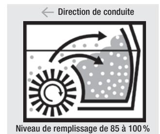
Efficacité : le principe de balayage à grande vitesse de rotation permet de remplir à 100 % la cuve à impuretés.
