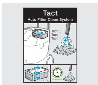
Aucune interruption : le nettoyage automatique du filtre Tact breveté présente une conception simple. Sa maintenance est aisée et il garantit une puissance d'aspiration élevée et constante.
