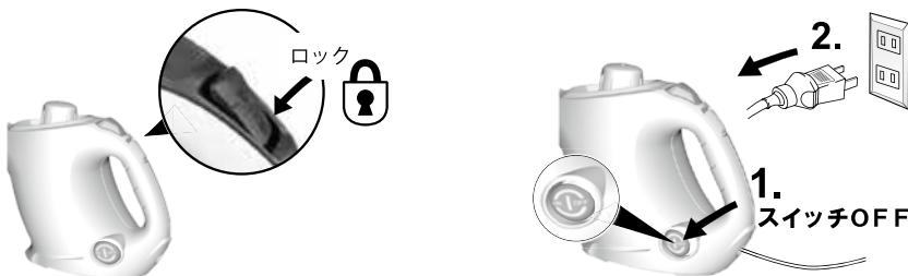
スチームボタンをロックし、スイッチを押して電源を切り、コンセントから電源プラグを抜いてください。
