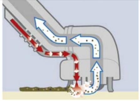
Unser Dampfsauger kann saugen, dampfreinigen und trocknen – in einem Arbeitsgang. Damit ist er selbst für große Flächen aus Fliesen, Naturstein oder PVC ideal.
