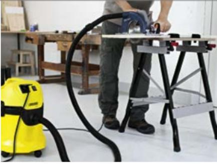
Steckdose mit Ein- und Ausschalt-automatik. Beim Anschluss von Elektrowerkzeugen kann Schmutz schon beim Entstehen abgesaugt werden (nur MV 3 P Extension Kit).
