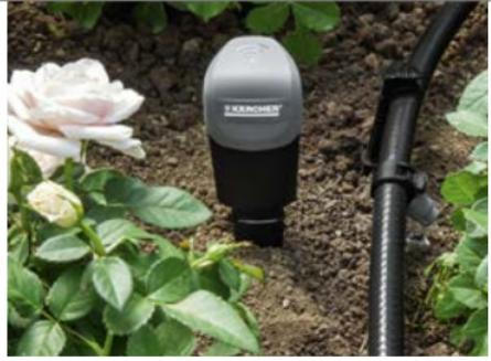
Kabellos wird der gemessene Feuchtigkeitswert des Bodens alle 30 min. per Funk vom Sensor an den SensoTimer übermittelt.
