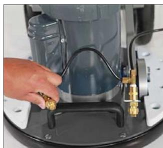
Le réglage des buses de pulvérisation permet de nettoyer dans n'importe quelle direction.
