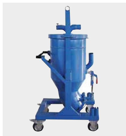
Предварителен сепаратор 110 литров с капак, халки за повдигане с кран, годен за преместване, транспорт с вилков електрокар, изпразване през клапа, за насипни продукти, пясък, сив чугун и др.
