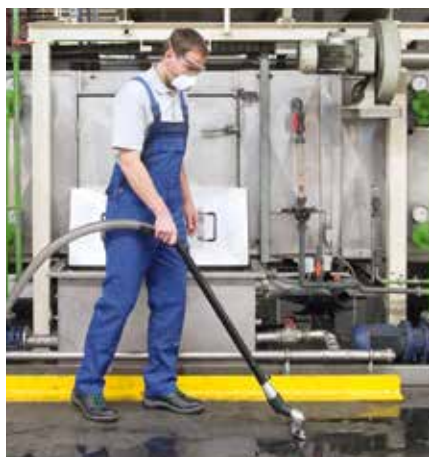
Изсмукване на течности, емулсии и масла при почистването на цеха
