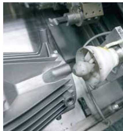
Дюза с триизмерен печат за специални задачи по изсмукване
