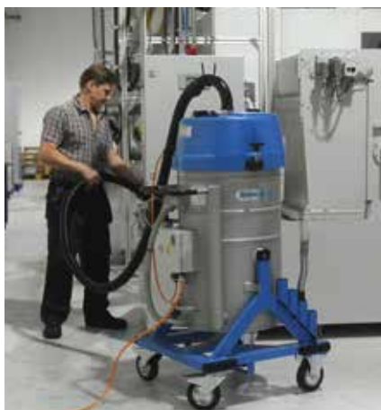
Изсмукване на хладилни масла при смяна
