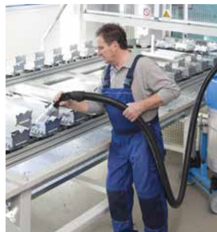
Засмукване на стружки и хладилни масла при ремонт на машини и инсталации
