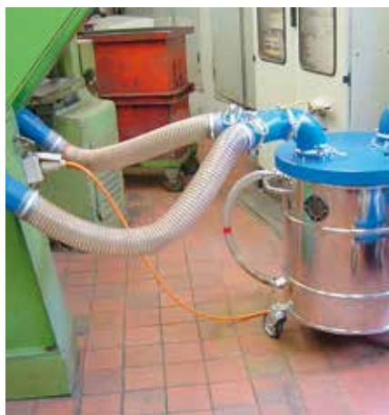
Подходящ за отделяне на искри и на прилепващи, много леки и проблемни технологични среди
