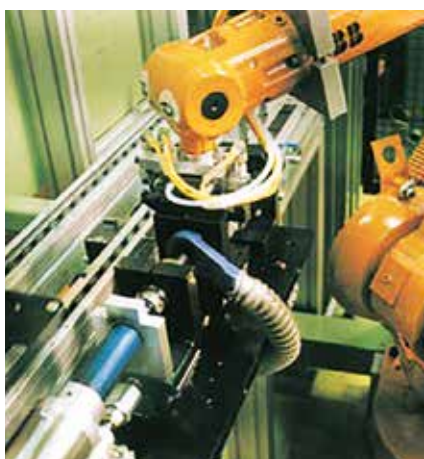
Смукателна дюза на Ringler за точно изсмукване на стружките от фрезоване
