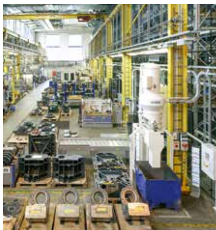
Централно съоръжение за изсмукване като система с много места в металообработващата промишленост
