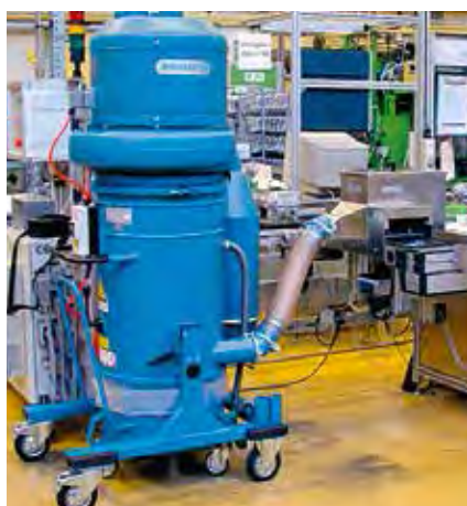
Otprašivači integrisani u proizvodnim linijama
