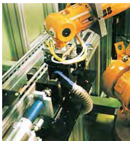
Ringler usisna mlaznica za tačkasto usisavanje opiljaka od glodalice
