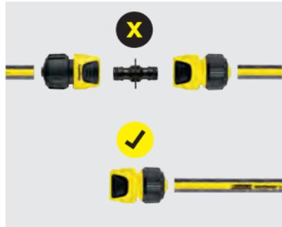
Verwenden Sie im Idealfall einen durchgängigen Schlauch oder so wenige Verbindungsstücke wie möglich. Zu viele Verbindungsstücke verringern Durchfluss und Druck - dadurch wird bei der Ausbringung über die Spritze, den Sprinkler etc. nicht die volle Leistung erreicht.
