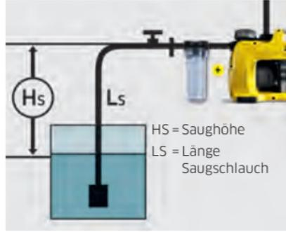
Stellen Sie die Pumpe so nah wie möglich an die Wasserquelle. Die beste Leistung erzielen Sie, wenn die Ansaughöhe möglichst niedrig ist. Sprich: kleine Saughöhe sowie kurzer und dicker Schlauch.
