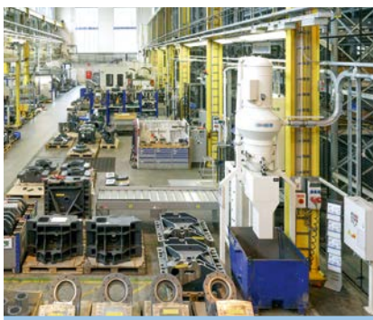
Zentrale Absauganlage als Mehrplatzsystem in der metallverarbeitenden Industrie
