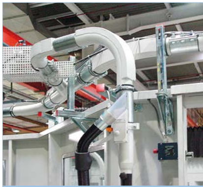
● Rohrleitungssystem mit elektropneumatischem Schieber und elektrischen Steuereinheiten
