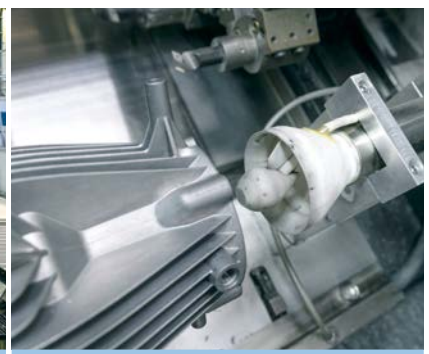
Düse im 3D-Druck für besondere Absaugaufgaben
