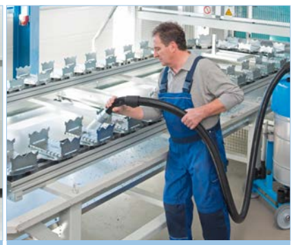
Späne- und Kühlschmierstoffabsaugung bei der Maschinen- und Anlageninstandhaltung
