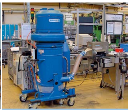
Entstauber in Fertigungslinien integriert
