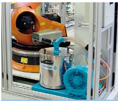
RA 40 integriert in Roboterzelle
