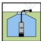
Die Tauchdruckpumpe BP Cistern ermöglicht die Wassergewinnung aus alternativen Quellen wie Zisternen, Regenfässern oder breiten Brunnenschächten und eignet sich somit ideal für die Gartenbewässerung. Die Pumpe arbeitet unter Wasser und schaltet automatisch ab, sobald der Wasserstand zu niedrig wird.
