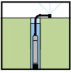
Mit Hilfe der kompakten und flexiblen Edelstahl-Tauchdruckpumpen von Kärcher lassen sich selbst Tiefbrunnen in Verbindung mit einem Druckschalter sogar zur Brauchwasserversorgung im Haus zur ressourcenschonenden Bewässerung nutzen. Die mehrstufige Hydraulik sorgt dafür, dass Brunnen-, Grund- und Quellwasser auch aus tiefer liegenden Bereichen mit ausreichend Druck gefördert werden.
