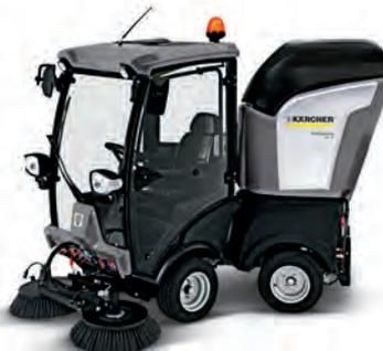
Balayeuses aspirantes mobiles performantes avec système d'aspiration ecoefficiency, système de circulation de l'eau et direction articulée.
