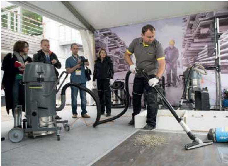
Индустриальные пылесосы способны удалять самые разные загрязнения и отходы производства, будь то металлическая стружка, маслянистые жидкости, крупный и мелкий мусор или взрывоопасная пыль. Особенности конструкции, в том числе специальные фильтры, насадки, прочные шланги, мощные турбины, — все рассчитано на долгую интенсивную эксплуатацию.
