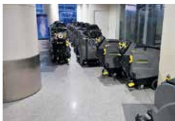
» Пространство большое, но открытых площадок практически нет, поэтому мы используем маневренные аккумуляторные модели. На входе работают В 60 W с ручным управлением, в залах — машины с сиденьем для оператора В 150 R, в багажном отделении с наливными полами — более мощные В 250 R.
