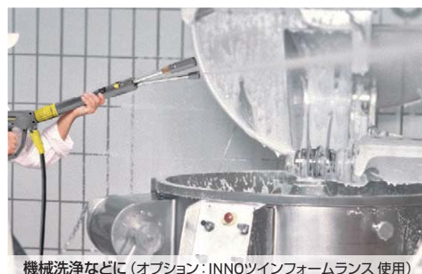
機械洗浄などに（オプション：INNOツインフォームランス 使用）
