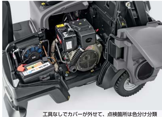
工具なしでカバーが外せて、点検箇所は色分け分類
