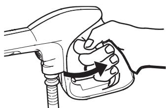
約15~30秒レバーを握るとホースの中の空気が抜け、水圧が安定します。
