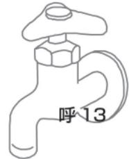
内径 15mm の水道ホースが確実に取り付けられる丸蛇口で使用できます。
