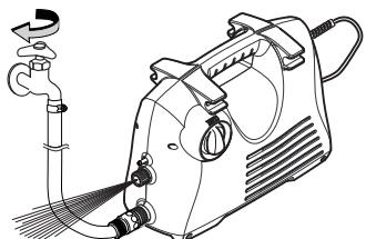
付属の水道ホースを本体と蛇口に取り付け水道栓を全開にし、高圧ホース接続口から勢いよく水が出来れば本体の呼び水は完了です。
