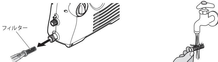
先端が平らなペンチなどで、給水口内部からフィルターを引き抜いてください。
