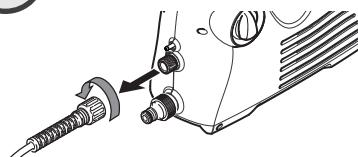
本体のスイッチが OFF(0) になっていることを確認します。高圧ホースのナットを矢印の方向に回し、本体から取り外してください。
