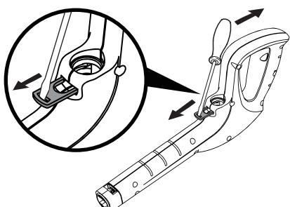
②矢印の方向にドライバーをひねり、フックを完全に引き出してください。
