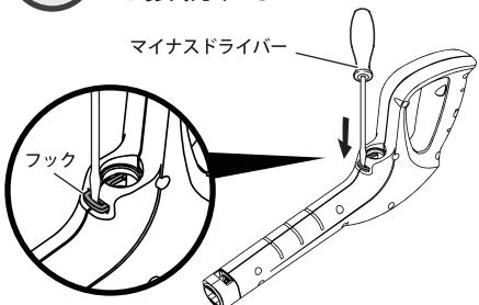
①トリガーガンを下に向けます。取り付けられているフックの穴に、マイナスドライバーなどを引っ掛けます。
