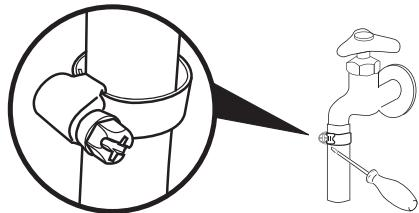
水道ホースを蛇口に差し込み、ドライバーを使ってホースバンドを固定してください。
