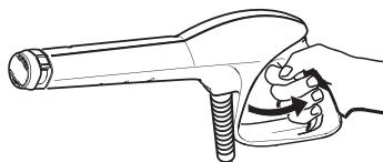
ノズルを取り外し、トリガーガンのレバーを握って、ポンプの残留圧力と残水を抜いてください。
