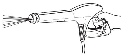
約15～30秒間レバーを握るとホースの中の空気が抜け、水圧が安定します。水が安定して出ると準備完了です。
