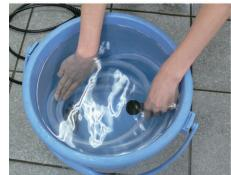
サクションホースをため水に沈めてください。ホース内に十分に水が入ってから先端部分を元通りに取り付けてください。
