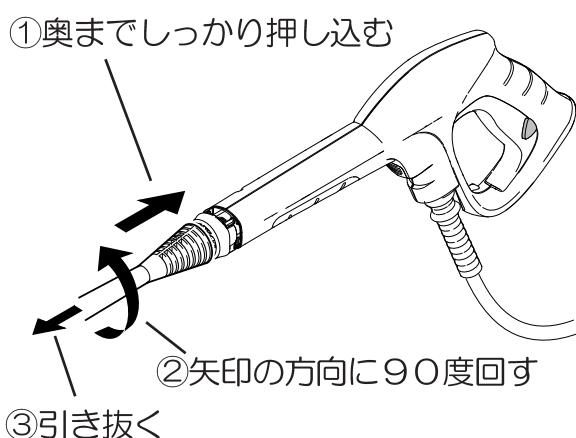
ノズルをトリガーガンの奥まで押し込みながら矢印の方向に回し引き抜いてください。
