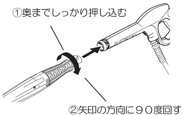
ノズルをトリガーガンに奥までしっかりと押し込みながら矢印の方向に90度回してください。
