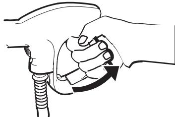
トリガーガンのレバーを握りポンプ内の残留圧力を抜き、レバーを放してください。
