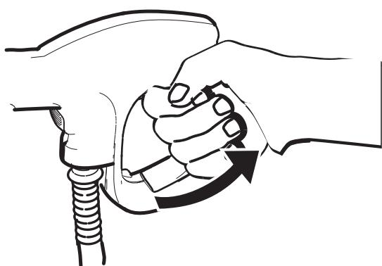
約15~30秒間ガンのレバーを握り水を出し続けるとホースの中の空気が抜け水圧が安定します。
