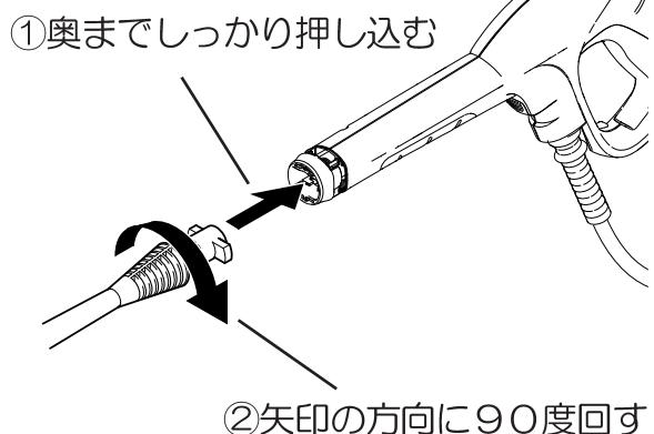
ノズルをトリガーガンに奥までしっかりと押し込みながら矢印の方向に90度回してください。
