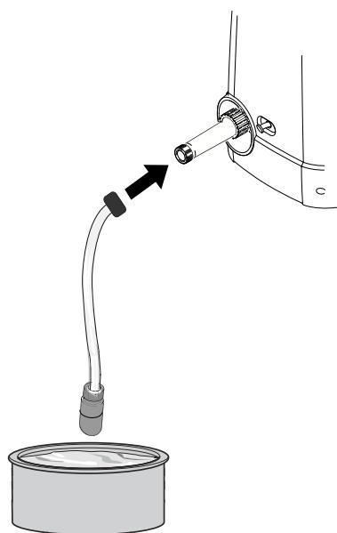
先端のフィルター部分を貯め水に沈めてください。
