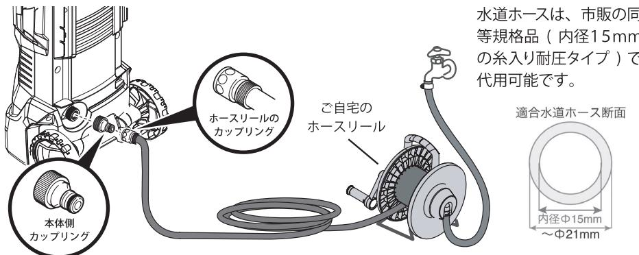
カップリングがついていない場合は、付属の水道ホースセットのホース側カップリングを、ご自宅のホースリールに付け替えてご使用ください。
