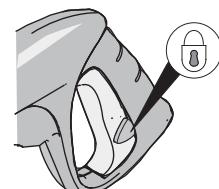
トリガーガンのレバーを手で完全に下げ、安全ボタンを押しロックしてください。
