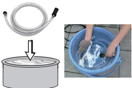
サクションホースをため水に沈めてください。ホース内に十分に水が入ってから先端部分を元通りに取り付けてください。
