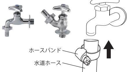
水道ホースを蛇口に差し込み、ドライバーを使ってホースバンドを固定します。
