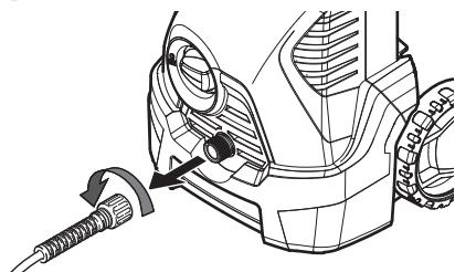
高圧ホースのナットを矢印の方向に回し、本体から取り外してください。
