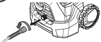
本体のスイッチが OFF(0) になっていることを確認し、高圧ホースを矢印の方向に回して本体から取り外してください。
