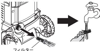
ペンチなどで吸水口内部からフィルターを引き抜き、流水ですす洗いをしてください。
