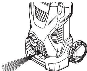
コンセントに電源プラグを差し込みスイッチを入れ、高圧ホース接続口から勢いよく水が出れば準備完了です。
