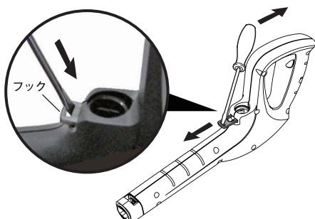
1. トリガーガンを裏返します。接続口に取り付けられているフックに、マイナスドライバーなどを差し込みます。
