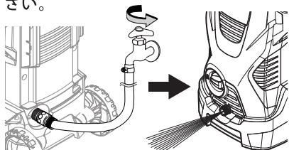
付属の水道ホースを本体と蛇口に取り付け水道栓を全開にし、高圧ホース接続口から勢いよく水が出れば本体の呼び水は完了です。
