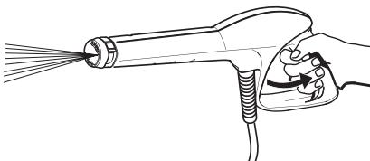
約15～30秒間レバーを握るとホースの中の空気が抜け、水圧が安定します。水が安定して出ると準備完了です。
