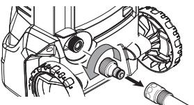
水道栓を閉めて、水道ホースと本体側カップリングを取り外してください。
