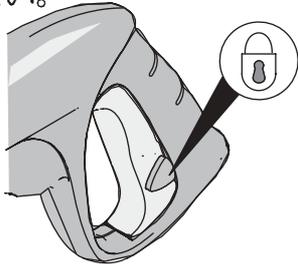
②ノズルを押し、左回りに回して取外します。
