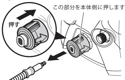
クイックカップリングを本体側に押しながら、高圧ホースを引き抜きます。
