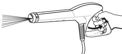
約15~30秒間レバーを握るとホースの中の空気が抜け、水圧が安定します。レバーを握り、水が安定して出ると準備完了です。
