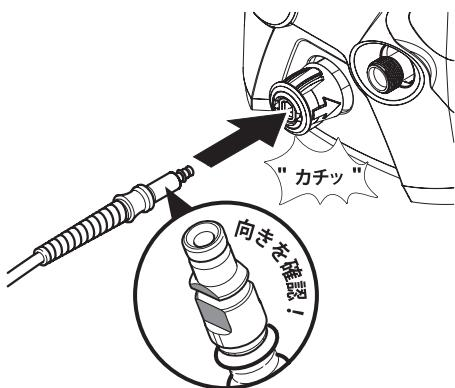
高圧ホース先端の平らな面と、クイックカップリングの平らな面が合うように接続してください。
