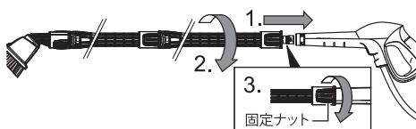
1. トリガーガン先端に、先ほど組み立てたデッキクリーナーをしっかりと押し込みます。
