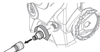
水道栓を閉めて、水道ホースと本体側カップリングを取り外してください。
