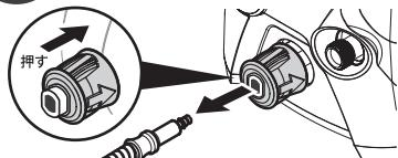
本体のスイッチが OFF(0) になっていることを確認します。クイックカップリングを本体側に押しながら、高圧ホースを引き抜きます。
