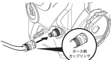
水道ホースのホース側カップリングを、本体側カップリングに奥までしっかりと差し込みます。取り付け後、水道栓を開けます。
