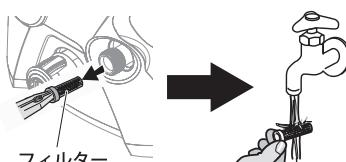
ベンチなどで吸水口内部からフィルターを引き抜き、流水ですすぎ洗いをしてください。
