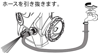
付属の水道ホースを本体と蛇口に取り付け水道栓を全開にし、高圧ホース接続口から勢いよく水が出れば本体の呼び水は完了です。
