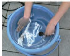
サクションホースをため水に沈めてください。ホース内に十分に水が入ってから先端部分を元通りに取り付けてください。
