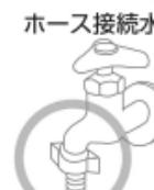
内径15mmの水道ホースが確実に取り付けられる丸蛇口でお使いいただけます。
