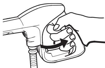
約15~30秒間レバーを握るとホースの中の空気が抜け、水圧が安定します。
