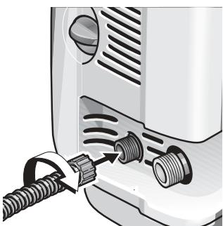
高圧ホース接続口にまっすぐ奥まで差込んでからナットをしっかりと締めます。斜めに差し込んだり、差込が悪い場合ナットが外れ破損します。
