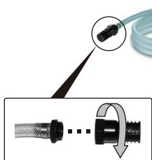
サクションホースセットの逆止弁側を取り外してください。※もう片方のナット側（フィルター接続側）は取り外せなくなっています。
