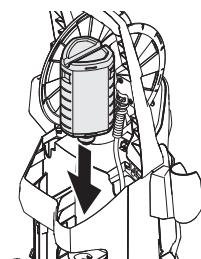
ユニバーサルクリーナーのキャップを外し、口を下にして洗浄剤タンクホルダーにセットしてください。
