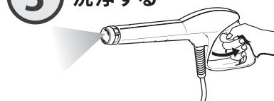
約15～30秒間、トリガーガンのレバーを握るとホースの中の空気が抜け、水圧が安定します。レバーを握り、水が安定して出ると準備完了です。
