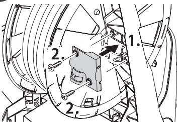
1. ホースリール取り付け部品をハンドル裏の取り付け部分に差し込みます。
