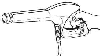
トリガーガンのレバーを握りポンプの残圧と残水を抜きレバーを放してください。
