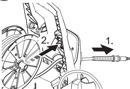
1. ホースリールを取り付ける前に洗剤調整ダイヤルへ高圧ホースを通します。
