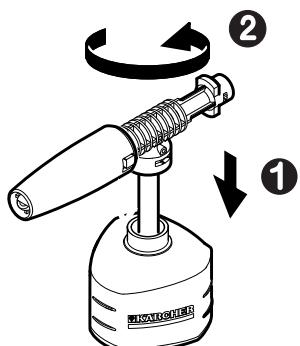
④トリガーガンの先端にフォームノズルを取り付けます。
