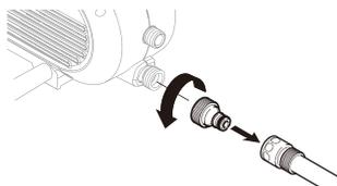
水道栓を開めて、水道ホースと本体側カップリングを取り外してください。
