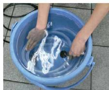
サクションホースをため水に沈めてください。ホース内に十分に水が入ってから先端部分を元通りに取り付けてください。
