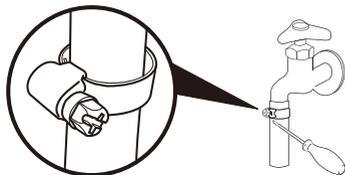
水道ホースを蛇口に差し込み、ドライバーでホースバンドを固定します。
