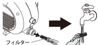
ペンチなどで吸水口内部からフィルターを引き抜き、流水ですす洗いをしてください。
