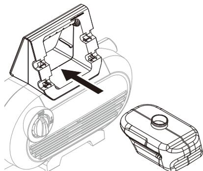
ハンドルの溝に洗剤タンクの溝を合わせて差し込み、止まるまで押し込んでください。
