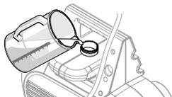
洗浄剤タンクのキャップを外し洗浄液をタンクに入れてください。
