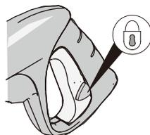
トリガーガンのレバーを手で完全に下げ、安全ボタンを押しロックしてください。
