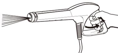
約15～30秒間レバーを握るとホースの中の空気が抜け、水が安定して出るようになれば準備完了です。
