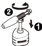
ヘッドを差し込み矢印の方向に回して固定してください。
