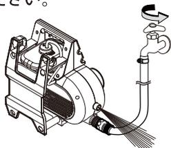
付属の水道ホースを本体と蛇口にに取り付け水道栓を全開にし、高圧ホース接続口から勢いよく水が出れば本体の呼び水は完了です。
