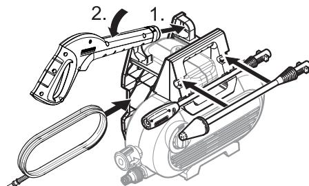
トリガーガンの先端を、収納用ホルダーに通し下に押込んで固定します。ノズルはハンドル部分のノズルホルダーに収納することができます。高圧ホースはホルダー部分にしまってください。
