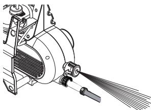
コンセントに電源プラグを差し込みスイッチを入れ、高圧ホース接続口から勢いよく水が出れば準備完了です。
