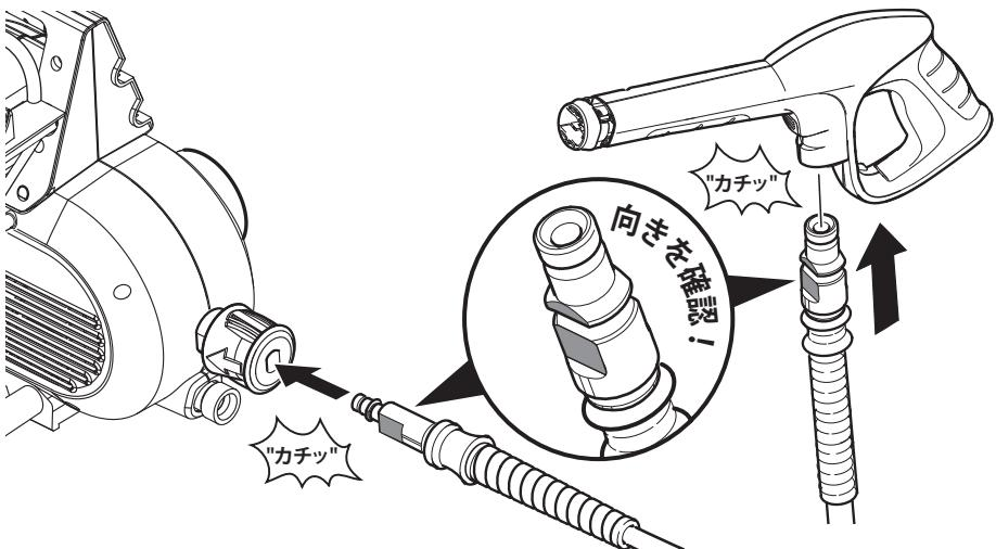
高圧ホース先端の平らな面と、各差込口の平らな面が合うように差し込み、“カチッ”と音がするまでしっかりと押し込んで下さい。
