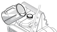
洗浄剤タンクのキャップを外し洗浄液をタンクに入れてください。
