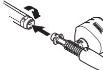
トリガーガンにノズルを差しこみ、矢印の方向に回して固定してください。
