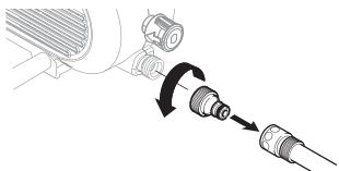
水道栓を閉めて、水道ホースと本体側カップリングを取り外してください。
