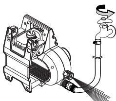
付属の水道ホースを本体と蛇口に取り付け水道栓を全開にし、高圧ホース接続口から勢いよく水が出れば本体の呼び水は完了です。
