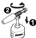
ヘッドを差し込み矢印の方向に回して固定してください。
