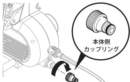
本体側カップリングを矢印の方向に回し、本体の給水口に取り付けます。
