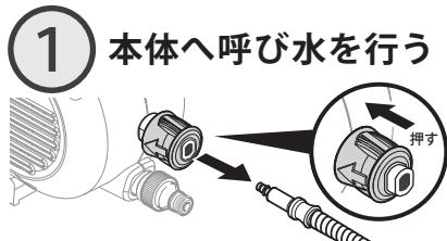
本体のスイッチが OFF(0) になっていることを確認します。クイックカップリングを本体側に押しながら、高圧ホースを引き抜いてください。
