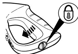
トリガーガンのレバーを手で完全に下げ、安全つまみが横の状態になるよう指で回し、ロックしてください。
