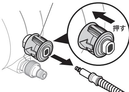
クイックカップリングを本体側に押ししながら、高圧ホースを引き抜きます。
