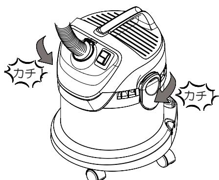
本体上部をタンクに取り付け、カバーロックを閉じて固定してください。
