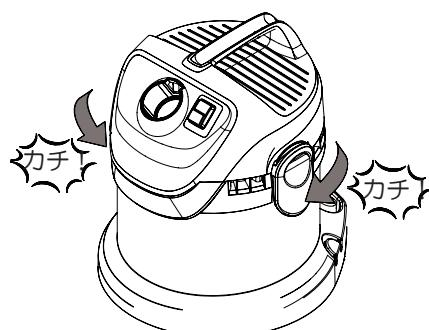
本体上部をタンクに取り付け、カバーロックを閉じて固定してください。
