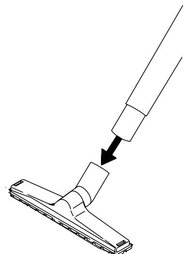
パイプ先端にノズルを取り付けてください。
