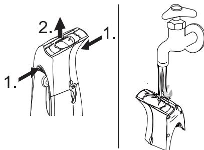
4 汚水タンクを外し、タンクの中を水洗いしてください。
