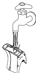
4 汚水タンクを外し、タンクの中を水洗いしてください。
