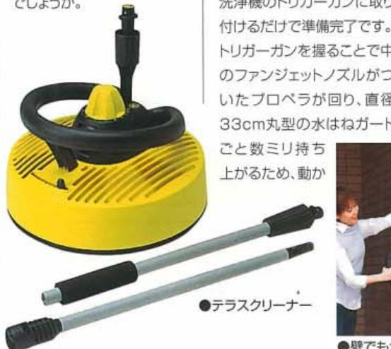
テラスクリーナーは、広い範囲の床面や壁を、かるく、しかも水はねなしで洗浄できるアクセサリーです。高圧洗浄機のトリガーガンに取り付けるだけで準備完了です。トリガーガンを握ることで中のファンジェットノズルがついたプロペラが回り、直径33cm丸型の水はねガードごと数ミリ持ち上がるため、動か
