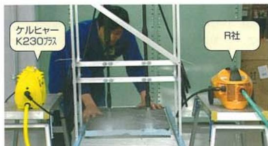
まず、一般洗浄用の高圧ノズルをそれぞれセットしました。ケルヒヤーは1ジェットノズル、R社はバリアルノズルです。
