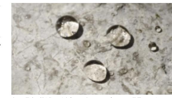
表面に撥水の膜を作ります(プロテクト)。ストーンプロテクター使用イメージ
