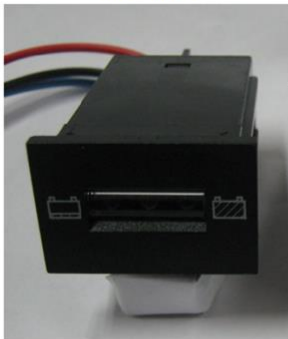
Indicador de carga antigo com corte de tensão = 19,8V.
