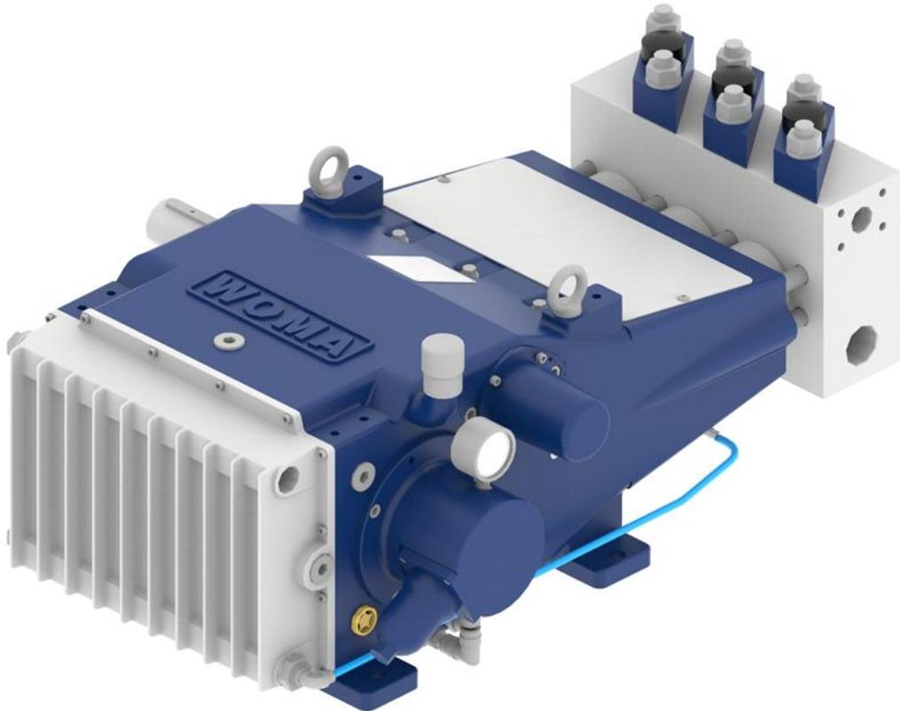
Las bombas de émbolo buzo de alta presión de la serie 2 con presiones de servicio de hasta 750 bares y caudales nominales suministrados de hasta aprox. 224 l/min son ideales para limpiar tuberías y haces de tubos, depósitos y contenedores. La variante V de la serie 2 ha sido desarrollada especialmente para aplicaciones con mayor presión previa.
