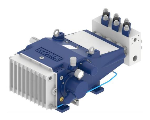
Les pompes refoulantes à piston plongeur à haute pression de la série 2 avec pressions de service allant jusqu'à 750 bar et débits nominaux allant jusqu'à 244 l/min sont idéales pour le nettoyage de tuyaux, de faisceaux tubulaires, de récipients et de conteneurs. La variante V de la série 2 a été spécialement conçue pour les applications avec pression d'admission élevée.
