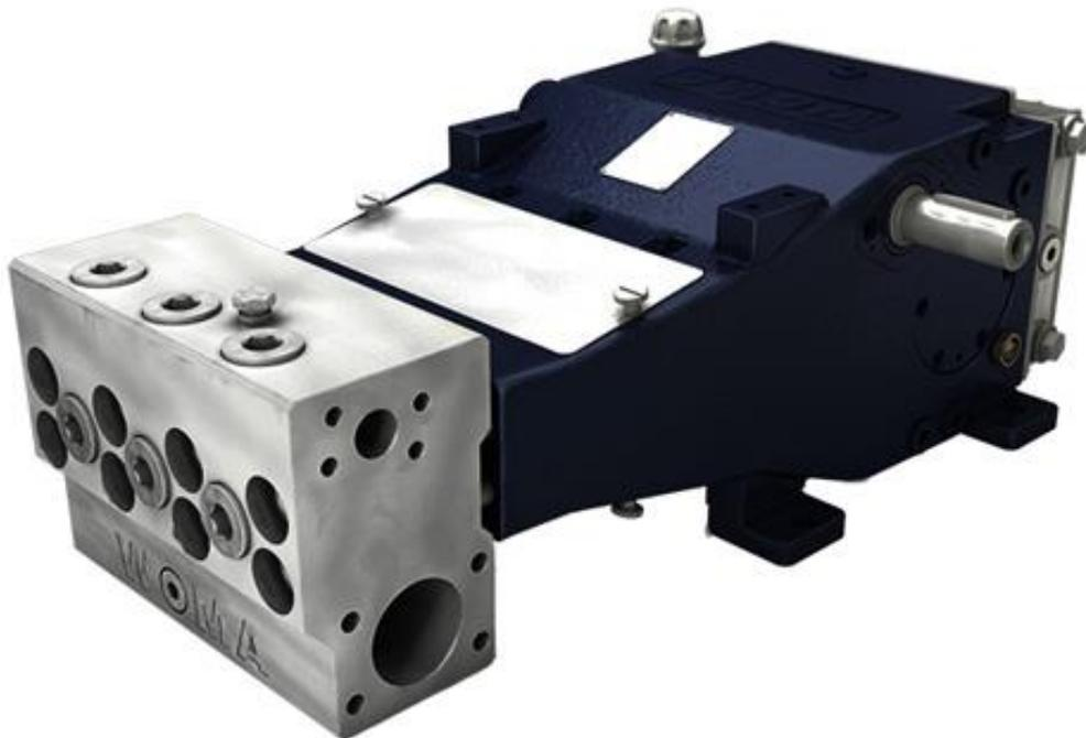
Des pressions de service allant jusqu'à 250 bar et des débits nominaux allant jusqu'à 403 l/min font de la série 3 la spécialiste du décalaminage et du nettoyage de tuyaux et de canaux.
