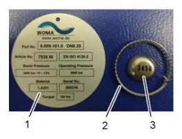
Вместе с каждой предохранительной мембраной поставляется этикетка С техническими характеристиками И крепежная проволока. Этикетку необходимо прикрепить к держателю предохранительной мембраны помощью крепежной проволоки. При установке сменной предохранительной мембраны необходимо строго соблюдать момент затяжки, указанный на этикетке соответствующей предохранительной мембраны.
