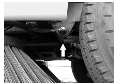
Punto di appoggio del cric (ruote anteriori)
