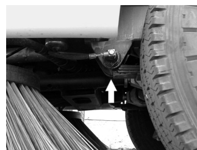
Punto de alojamiento para el gato (ruedas delanteras)
