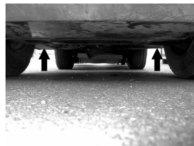
Aufnahmepunkt für Wagenheber (Hinterräder)
