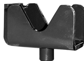
Punto de alojamiento para el gato (ruedas delanteras)
