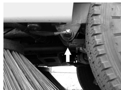
Punkt mocowania lewarka (do tylnych kół)
