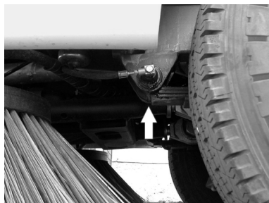
Aufnahmepunkt für Wagenheber (Vorderräder)
