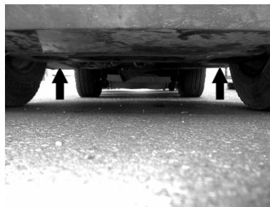
Точка установки домкрата (задние колеса)
