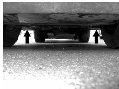
Punkt mocowania lewarka (do tylnych kół)
