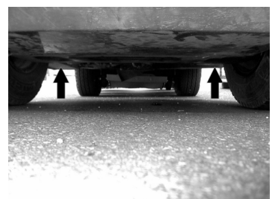
Ponto de apoio para o elevador do carro (rodas traseiras)
