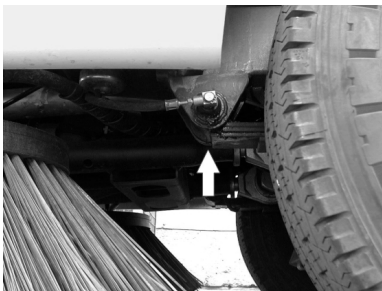
Σημείο υποδοχής γρύλου ανύψωσης (πρόσθιοι τροχοί)
