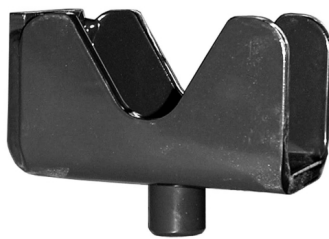
Точка установки домкрата (передние колеса)
