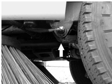
Optagelsespunkt til donkraften (forhjul)
