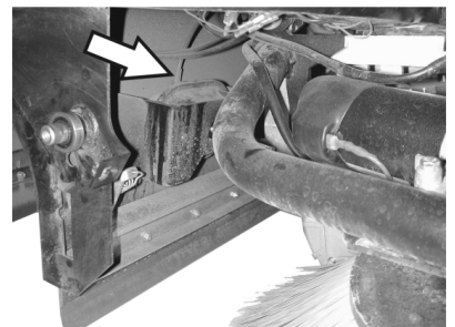
Slangaansluiting naar de onderdrukdoos voor het omlaag brengen van de zijbezem
