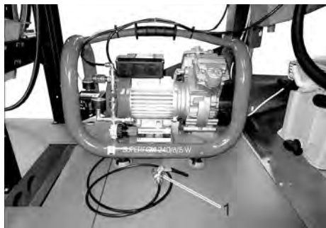
1 Kondensāta iztecināšanas vārsts
