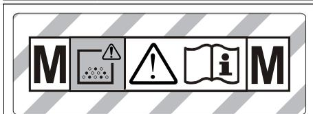
**WARNING:** Denna maskin innehåller hälsovådligt damm. Tömning och skötsel inkl demontering av dammpåsen får endast göras av särskilt utbildad personal med lämplig skyddsklädsel. Koppla ej till innan hela filtersystemet är installerat och volymströmkontrollens funktion kontrollerats.
