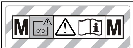
**UPOZORENJE:** Ovaj uređaj sadrži prašinu štetnu po zdravlje. Pražnjenje i održavanje, kao i odstranjivanje kese za prašinu smeju obavljati samo stručne osobe, koje nose odgovarajuću ličnu zaštitnu opremu. Ne uključivati, pre nego što se instalira kompletan filterski sistem i proveriti rad kontrole zapreminske struje.
