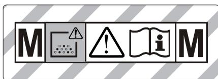
**OPOZORILO:** Ta naprava vsebuje združju škodljiv prah. Priznjenje in vzdrževanje naprave, vključno z zamenjavo vrečke za prah smejo opravljati samo strokovne osebe, ki so opremljene z ustrezno zaščitno opremo. Naprave ne vključujte, dokler ni vgrajen celoten filtrski sistem in ni bilo preverjeno funkcioniranje volumnskega pretoka.
