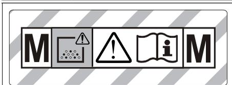
**HOIATUS:** Käesolev seade sisaldab tervist kahjustavat tolmu. Seadet tühendada ja hooldada ning tolmu-kotti eemaldada tohivad ainult asjatundjad, kellel on sobiv individuaalne kaitsevarustus. Mitte sisse lülitada, enne kui kogu filtrisüsteem on paigaldatud ja voolumahu kontrollseadist on testitud.
