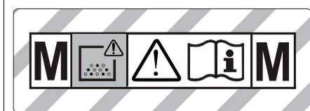
**ПРЕДОСТЕРЕЖЕНИЕ:** Этот прибор содержит опасную для здоровья пыль. Опорожнение и обслуживание, включая удаление мешка с пылью, должны проводиться только специалистами, которые имеют специальную индивидуальную защитную экипировку. Не следует включать прибор, прежде чем не установлен полный комплект системы фильтров и не проведена проверка функционирования контроля над объемом потока.
