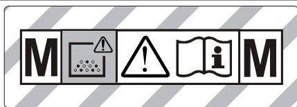
**UPOZORENJE:** Ovaj uređaj sadrži prašinu štetnu po zdravlje. Pražnjenje i održavanje, kao i odstranjivanje kese za prašinu smeju obavljati samo stručne osobe, koje nose odgovarajuću ličnu zaštitnu opremu. Ne isključivati, pre nego što se instalira kompletan filterski sistem i proveriti rad kontrole zapremine struje.
