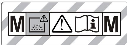
**VARNING:** Denna maskin innehåller hälsovådligt damm. Tömning och skötsel inkl demontering av dammpåsen får endast göras av särskilt utbildad personal med lämplig skyddsklädsel. Koppla ej till innan hela filterssystemet är installerat och volymströmkontrollens funktion kontrollerats.
