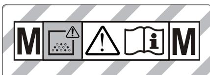
**UPOZORENJE:** Ovaj uređaj sadrži prašine opasne po zdravlje. Pražnjenje i održavanje, uključujući odstranjivanje vrećice s prašinom, smiju izvoditi samo stručne osobe, koje su opremljene prikladnom zaštitnom opremom. Ne uključivati prije nego je instaliran kompletan filterski sistem i prije nego je ispitana funkcija kontrole strujanja.
