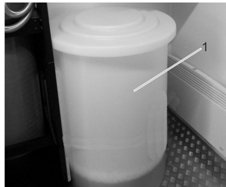
1 Tanque de sal
