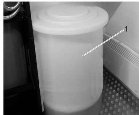
1 Tanque de sal
