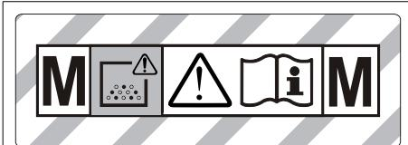
**HOIATUS:** Käesolev seade sisaldab terivist kahjustavat tolmu. Seadet tühjendada ja hooldada ning tolmukotti eemaldada tohivad ainult asjatundjad, kellel on sobiv individuaalne kaitsevarustus. Mitte sisse lülitada, enne kui kogu filtreerimisüsteem on paigaldatud ja voolumahu kontrollseadist on testitud.
